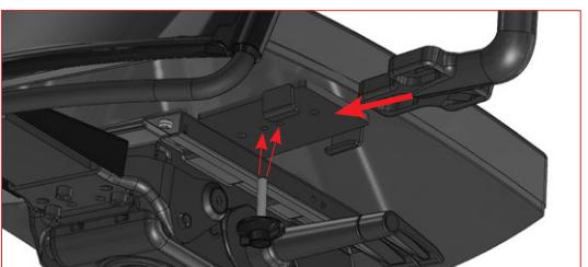
**DE** Montage Armlehnen beim Drehstuhl mit automatischer Gewichtseinstellung **EN** Assembly of arms in case of swivel chair with automatic weight adjustment **FR** Montage des accoudoirs sur le siège tournant avec réglage automatique du poids **NL** Montage van de armleggers bij bureaustoel met automatische gewichtsinstelling **CZ** Montáž područek u otočné židle s automatickým nastavením hmotnosti
