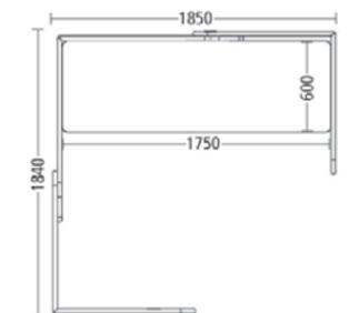
**m.zone Cell links – Arbeitsplatte Höhe 740 mm**
